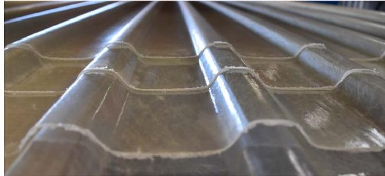
Der empfohlene Lattenabstand für die Schneelastzone 1,0 - 2,0 beträgt maximal 800 mm für MTP 21 sowie maximal 1000 mm für MTP 46.
