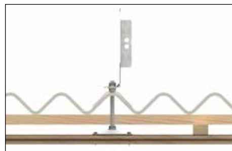
Borrade hål i fibercementtak
